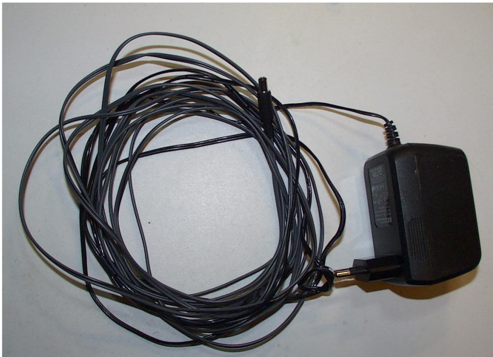
Kuva 2. AC muuntaja johon lisätty johdon pituutta ja johdon päähän laitettu DC plugi.
